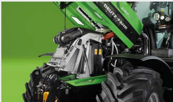
↑ Hliníkový chladiaci systém modelov 6160.4 - 6190 s jednoduchým prístupom a vzduchovým filterom Powercore so systémom cyklónového predčistenia.
