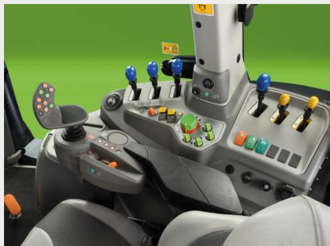
↑ Vybavenie kabíny MaxiVision s plne mechanickými zadnými hydraulickými okruhmi je dostupné pre modely Powershift (veľký obrázok) a RCshift (obrázok vyššie).
