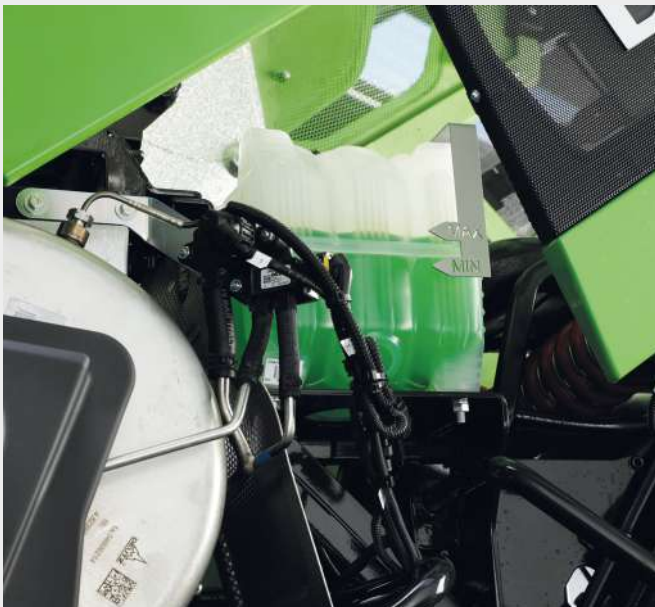
↑ Nádrž chladiacej kvapaliny s oceľovým ukazovateľom hladiny.
