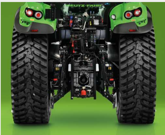
↑ Zadný záves s nosnosťou až 9700 kg.
