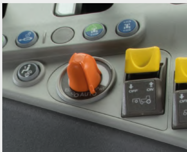
↑ Jednoduché a intuitívne – pomocou nastavovacieho gombíka Eco/Power môže obsluha zmeniť správanie pri radení APS (automatické radenie pod zaťažením).
