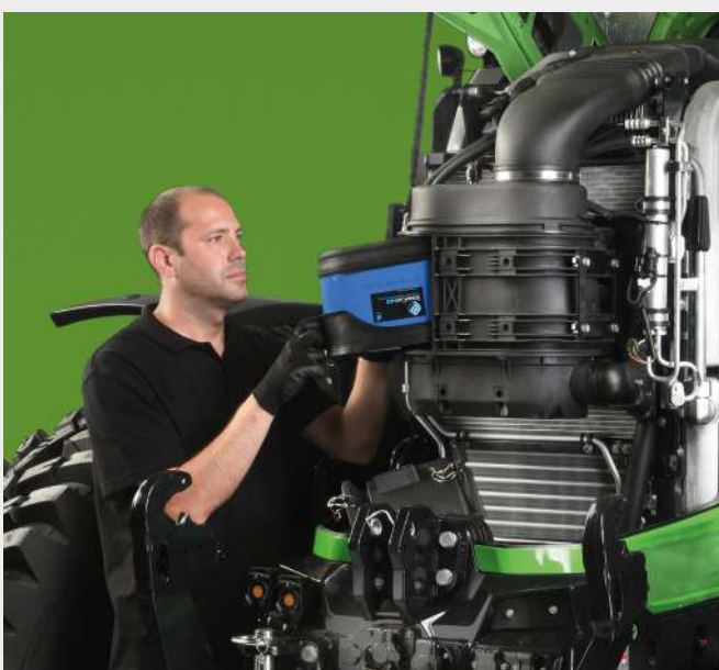
↑ Jednoduchý prístup k vzduchovému filteru PowerCore.
