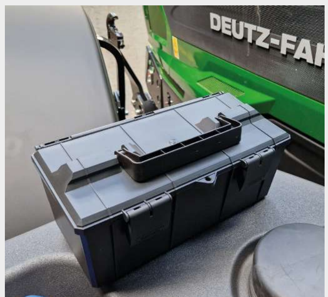
↑ Úložný box nad palivovou nádržou na ľavej strane pre vzduchovú hadicu a vzduchovú pištoľ.
