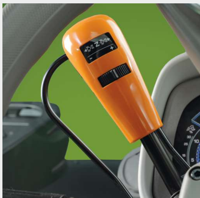
↑ Ergonomická páka PowerShuttle s nastavovacím kolieskom SenseClutch.
