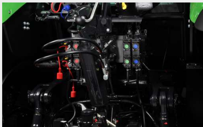
↑ Vysoký komfort spojený s jednoduchým používaním: zmiešaná hydraulická konfigurácia s dvoma elektrickými a dvoma mechanicky ovládanými okruhmi.
