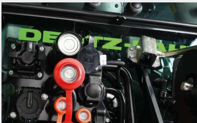
↑ Systém Power Beyond je k dispozícii so štandardnými alebo plochými spojkami.
