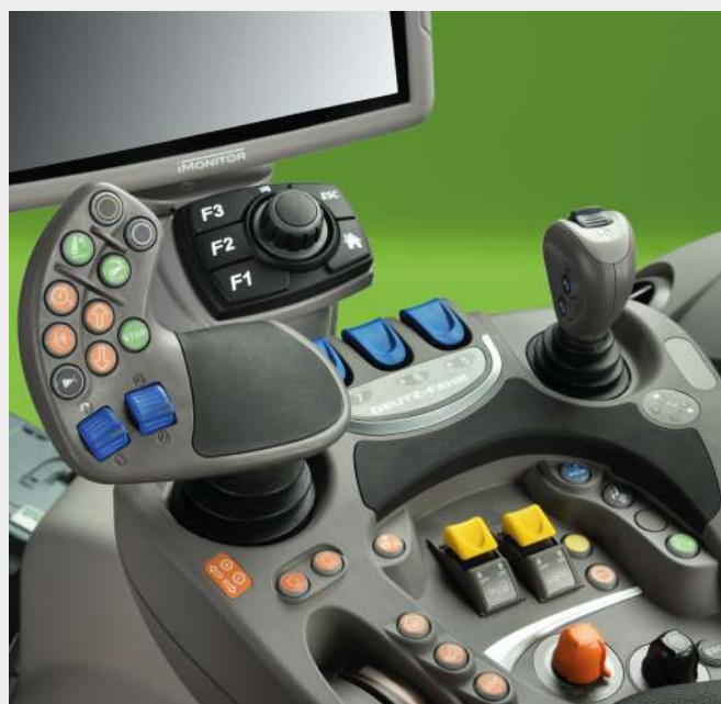
↑ Na ovládanie elektrických okruhov si obsluha môže vybrať medzi modrými kolískovými prepínačmi, malým joystickom alebo praktickými kolieskovými prepínačmi na joysticku MaxCom.
