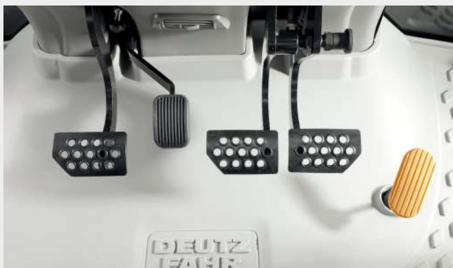
↑ Ergonomická aktivácia motorovej brzdy pedálom na podlahe.
