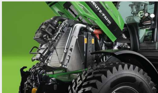
↑ Hliníkový chladiaci systém modelov 6210 a 6230 s jednoduchým prístupom a vzduchovým filterom Powercore s voliteľným systémom cyklónového predčistenia.
