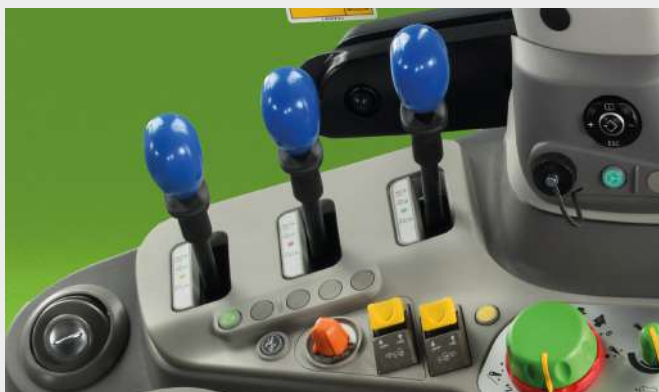
↑ Až 4 mechanické vonkajšie hydraulické okruhy s ergonomickým ovládaním jednou pákou.
