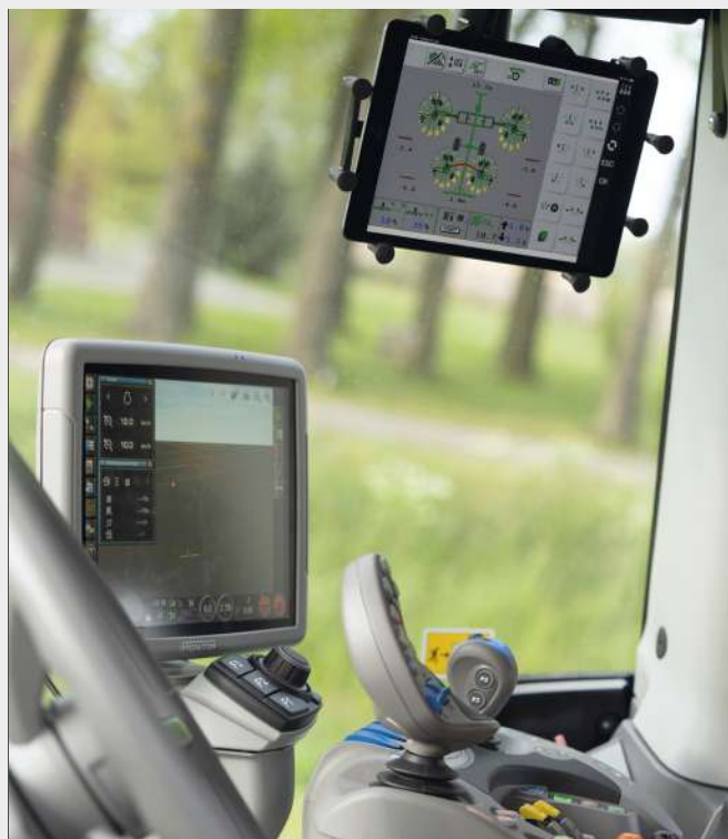
Funkcia XTEND umožňuje zobrazenie navádzania SDF alebo vám umožňuje ovládať ISOBUS náradie na externom zariadení, napr. tablete.
