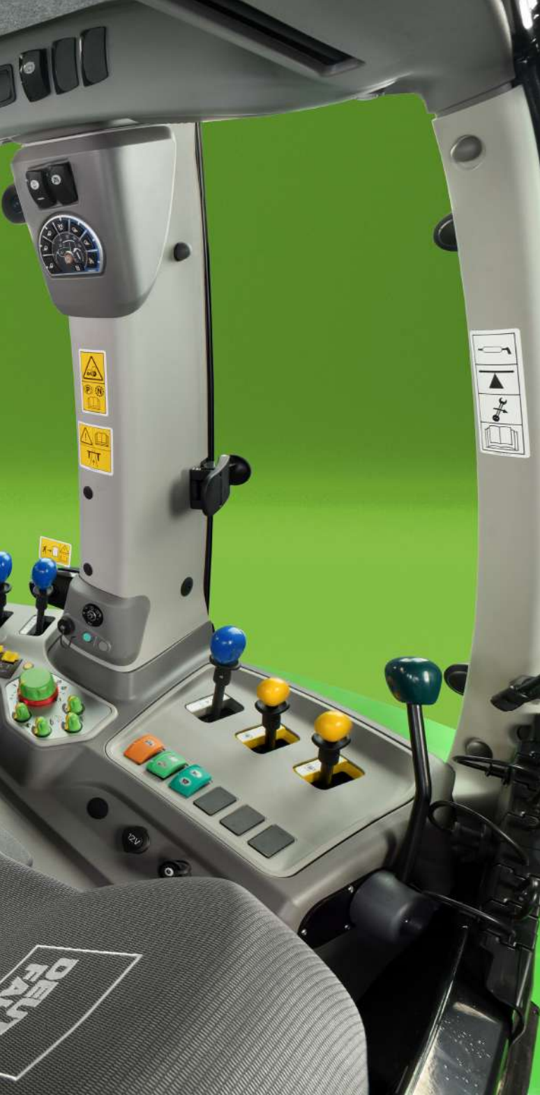
↑ Vybavenie kabíny MaxiVision s plne mechanickými zadnými hydraulickými okruhmi je dostupné pre modely Powershift (veľký obrázok) a RCshift (obrázok vyššie).
