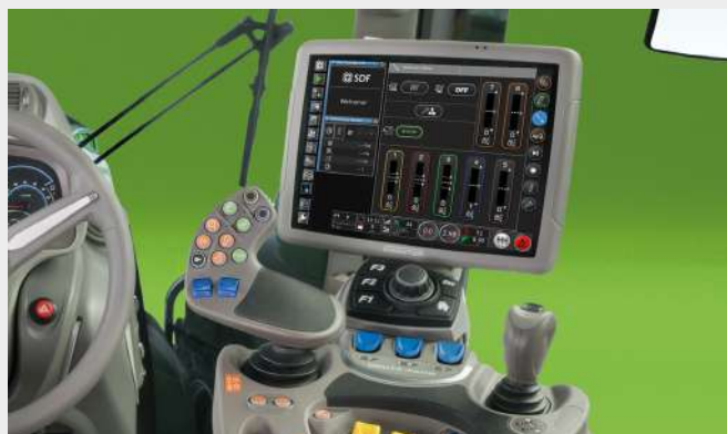
↑ Elektronické hydraulické okruhy s komfortnými elektrickými ovládacími prvkami.
