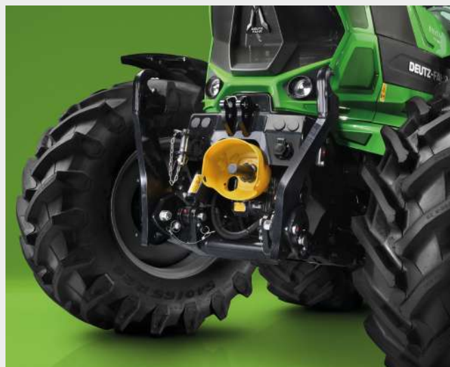
↑ Základné predné ramená s nosnosťou až 3800 kg a voliteľným predným vývodovým hriadeľom s režimom otáčok 1000.
