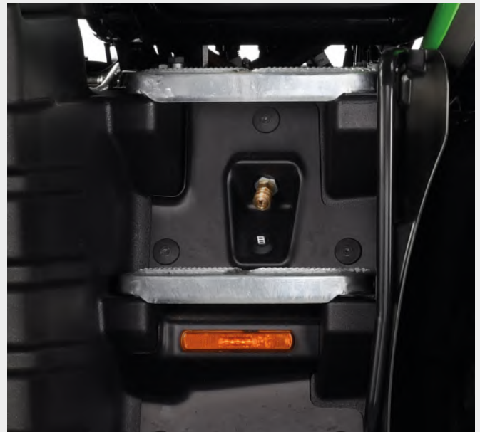
↑ Vývod stlačeného vzduchu a spínač vstupného svetla sú chránené pod schodíkmi.
