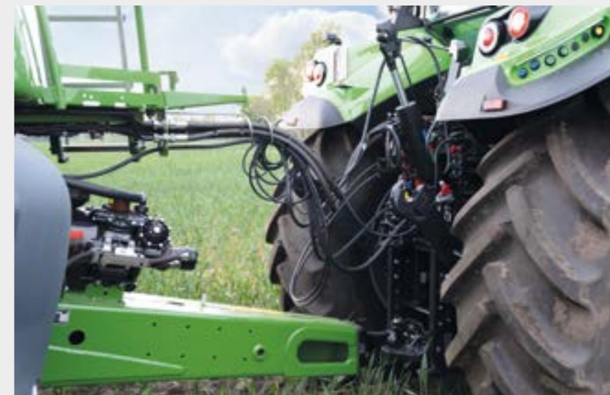
➤ Zadný záves v prepravnej polohe pre minimalizovanie zasahovania do oja pri jazde v zákrutách.
