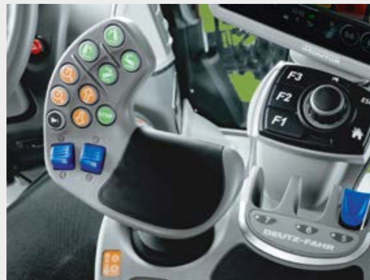
Ergonomický MaxCom joystick s ovládaním predných a zadných ramien, motora, prevodovky, úvratovým manažmentom a hydraulických okruhov s proporcionálnym ovládaním.
