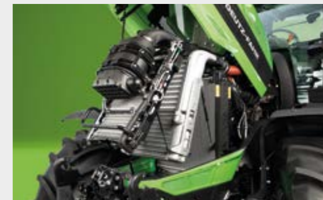
↑ Hliníkový systém chladičov s jednoduchým prístupom a Powercore vzduchovým filtrom.
