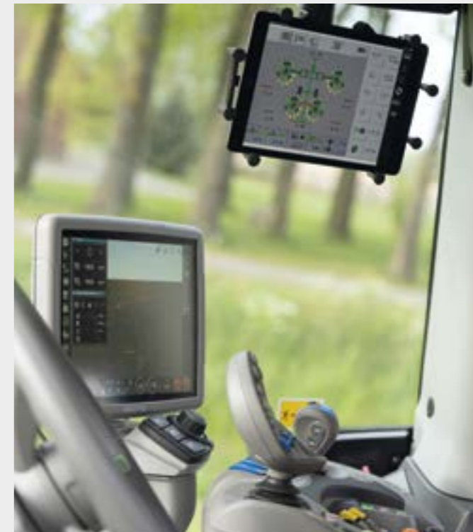
Funkcia XTEND umožňuje zobrazenie navádzania SDF alebo vám umožňuje ovládať ISOBUS náradie na externom zariadení, napr. tablete.
