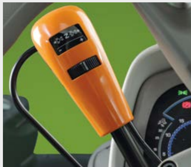
Reverzácia pojazdu PowerShuttle s funkciou komfortnej spojky Sense Clutch a piatimi nastaviteľnými úrovňami reakcie.
