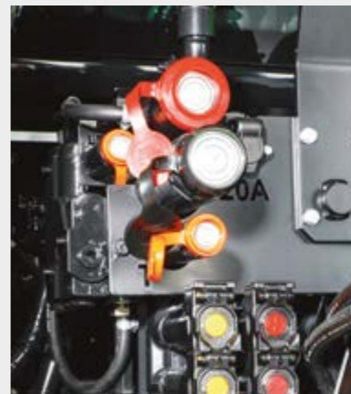
➤ Power Beyond s plochými spojkami pre jednoduché pripojenie.
