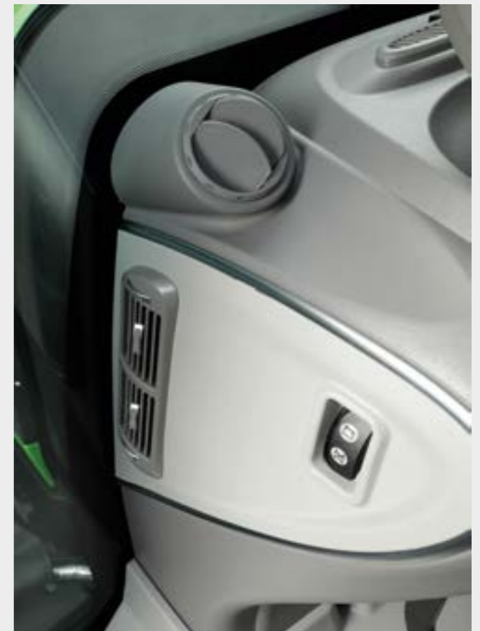
Prídavné dýzy klimatizácie a hlavný vypínač batérie komfortne umiestnený v kabíne.
