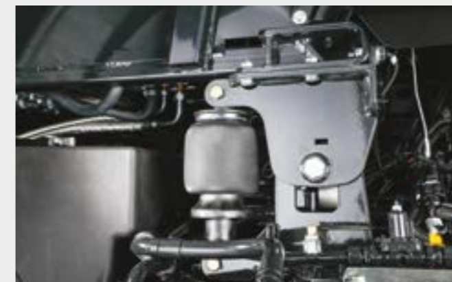
↑ Pneumaticky odpružená kabína pre maximálny komfort pri jazde.
