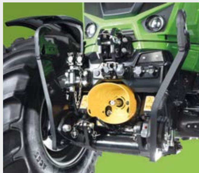
➤ Predná ramená so silou zdvihu 5 450 kg a DualSpeed vývodovým hriadeľom.
