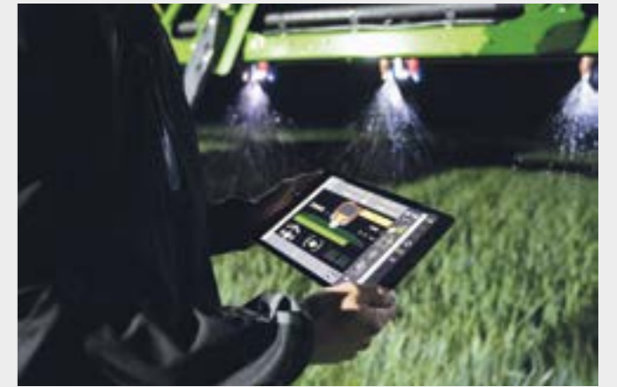
↑ Funkcia XTEND, ovládanie náradia s ISOBUS UT cez tablet mimo kabíny.
