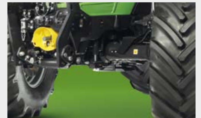
↑ Koncept predného odpruženia s veľkou svetlou výškou a 3 nastaviteľnými úrovňami v InfoCenter PRO .
