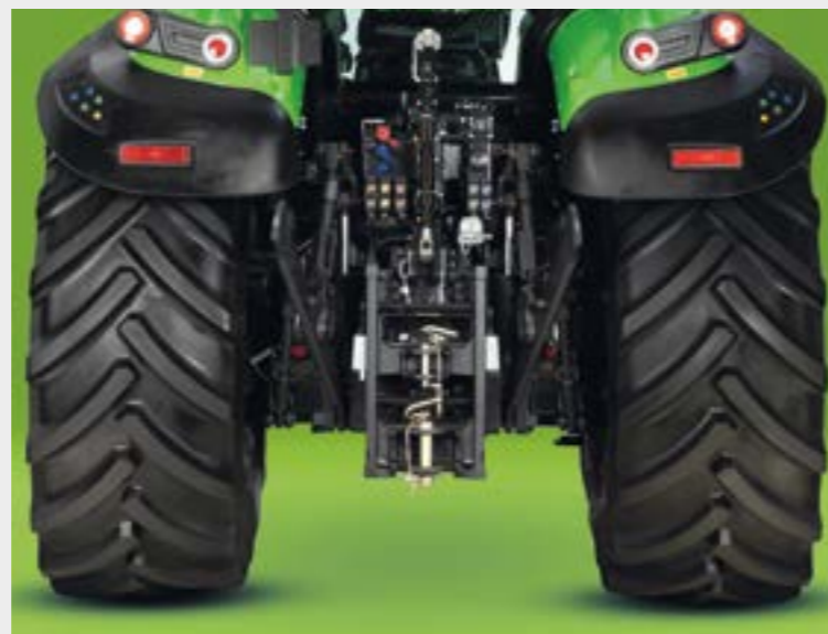
➤ Zadné ramená, 5 hydraulických okruhov a externé ovládanie na blatníkoch z oboch strán.
