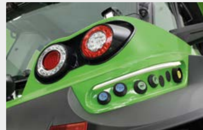
↑ Ovládacie prvky na oboch blatníkoch sú osvetlené pomocou LED pásiku.
