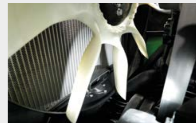
↑ Elektronicky ovládaný viskostatický ventilátor (eVisco) s nasávacou trubicou pre predčistenie vzduchu.
