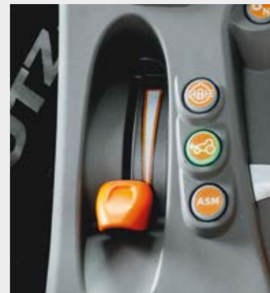
Nezávislý ručný plyn a elektro-hydraulicky aktivovaná uzávierka diferenciálu, náhon predných kolies a ASM automatická funkcia.
