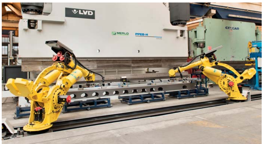
nové automatizované pracovisko a pracovisko pre presnú výrobu ramien
