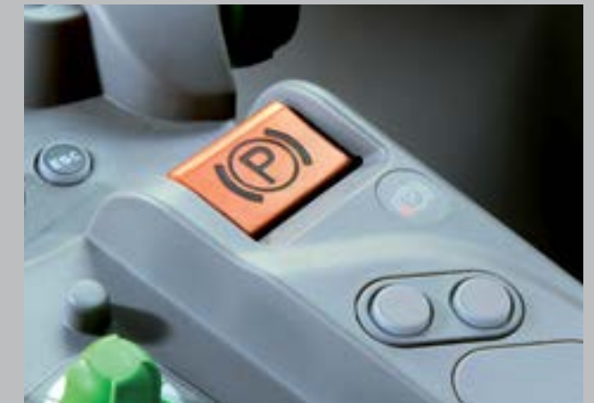
EPB. Maximálna bezpečnosť bez ohľadu na to, kde je rad 9 TTV odstavený.
