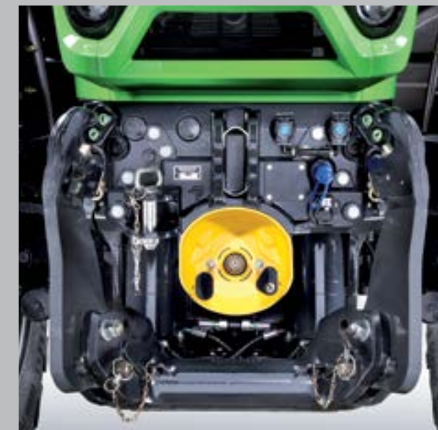
Integrovaný predný vývodový hriadeľ s jedinečnou krátkou vzdialenosťou od prednej nápravy, zabezpečujú krátky prevys a vynikajúcu stabilitu traktora.
