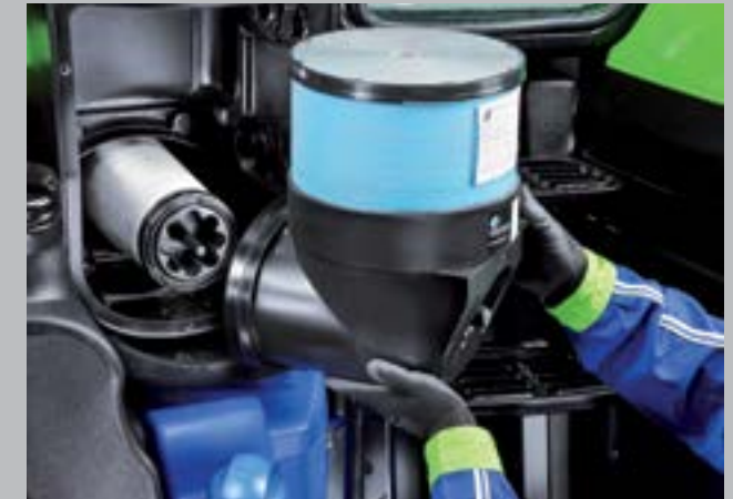
Vzduchový filter možno jednoducho a ľahko vymeniť.
