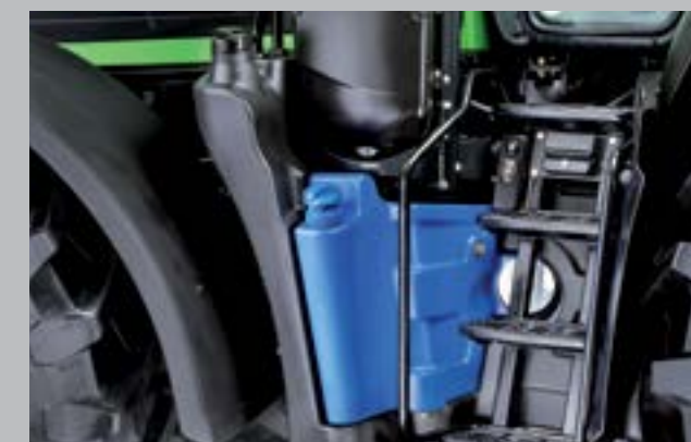
600 litrová nádrž na naftu a 55l AdBlue sú dostatočným objemom pre viac ako jednodňovú ťažkú prácu na poli. Vyhrev palivového filtra zjednodušuje studený štart.
