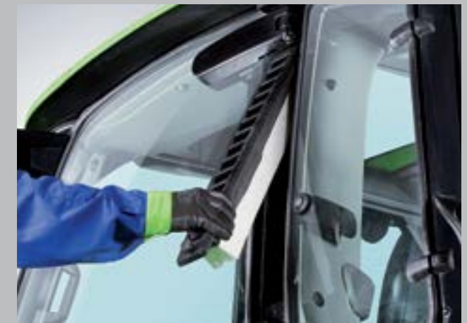
Vzduchový kabinový filter možno jednoducho vymeniť bez použitia náradia.
