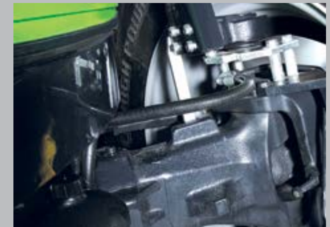
Predná náprava. Perfektné pruženie a uhol natočenia kolies až 50 stupňov.
