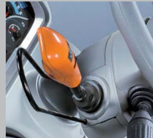
Elektrohydraulická reverzácia pojazdu pod zaťažením. Jednoduchou pohybom prsta možno nastaviť rozbehový moment (hard – medium – soft).
