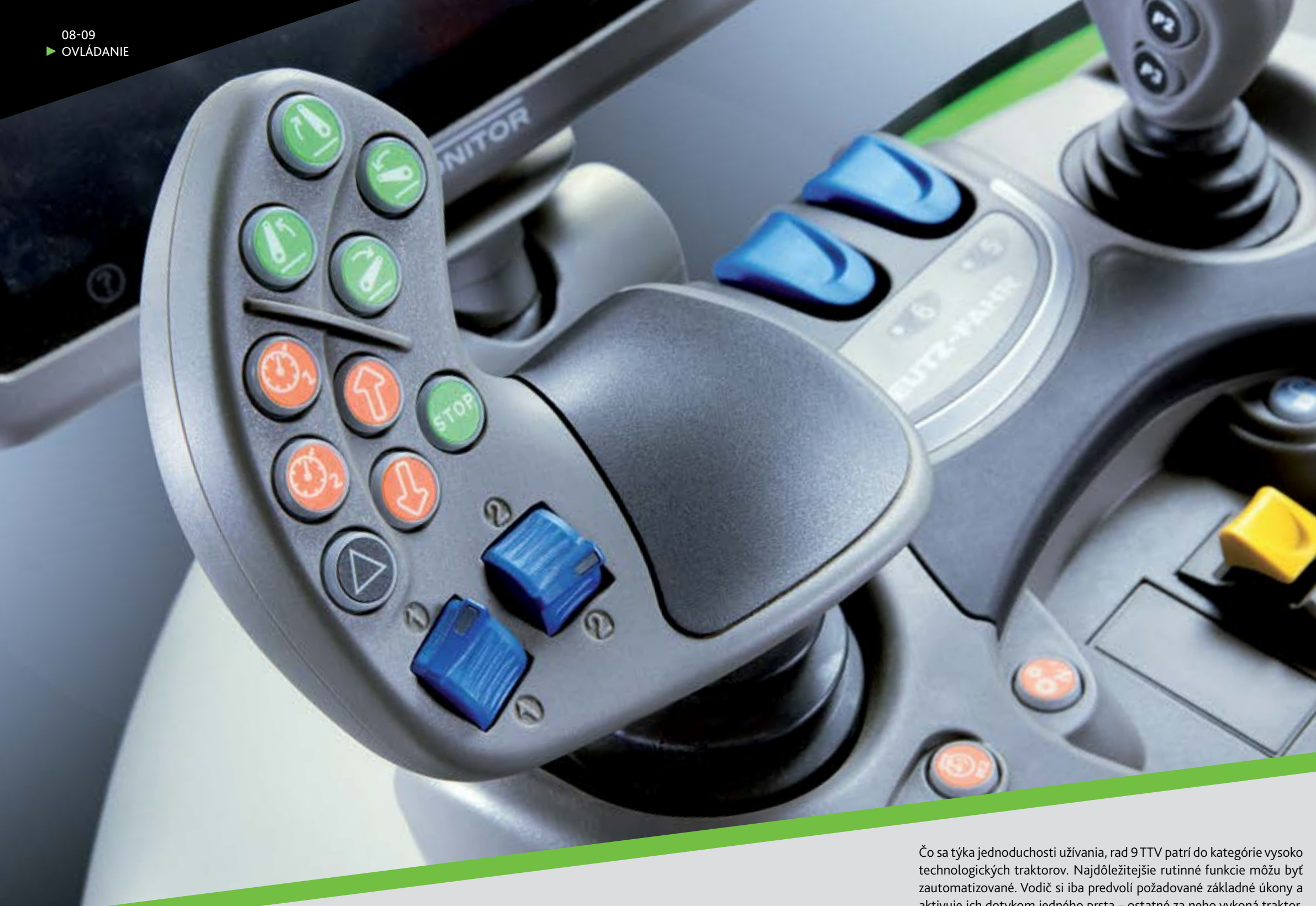
Tri hydraulické okruhy sú ovládané jedným joystickom s integrovaným ovládacím potenciometrom.
