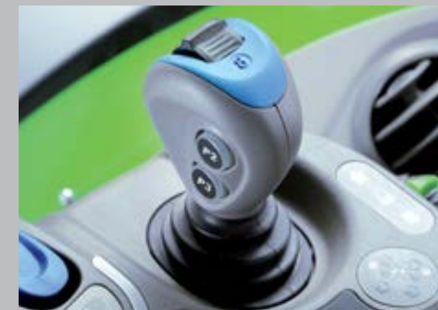
Tri hydraulické okruhy sú ovládané jedným joystickom s integrovaným ovládacím potenciometrom.
