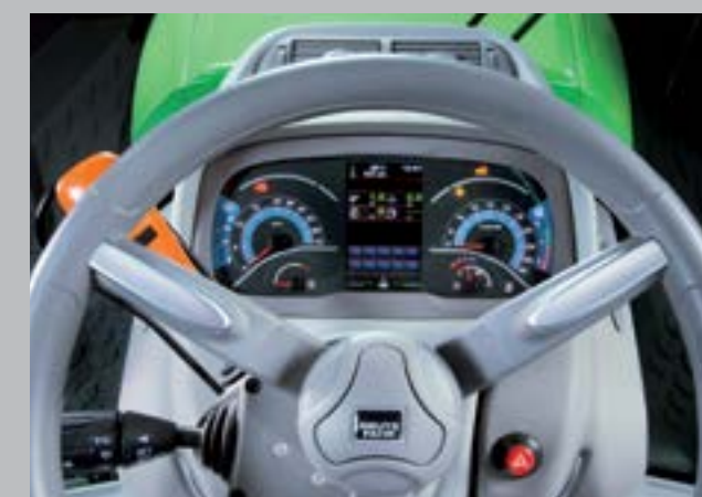
Nový InfoCenter poskytuje prehľad nad prevádzkovými parametrami - v digitálnom, aj analógovom zobrazení..
