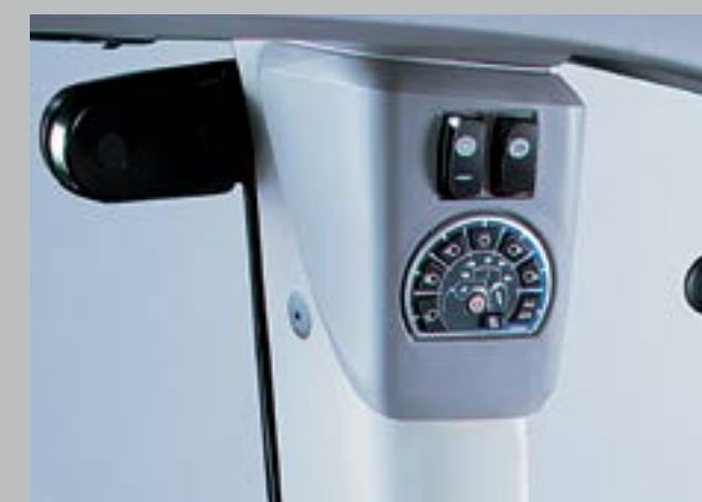
Ovládanie pracovných a stretávacích svetiel je zdužené na jednom prehľadnom ovládacom paneli.
