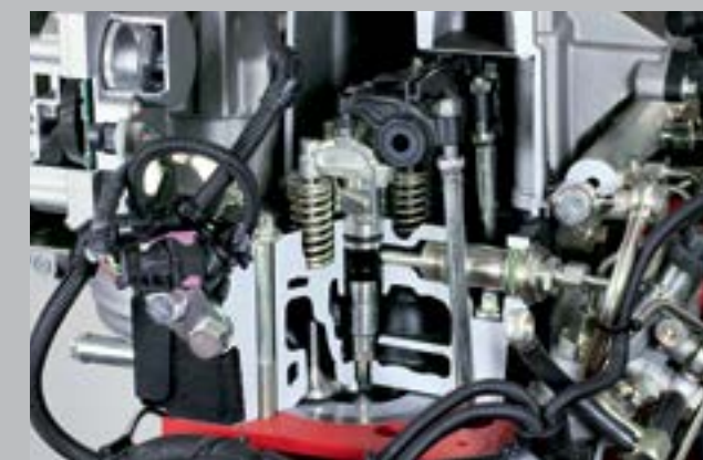
Technológia DCR. Vstrekovací tlak 2000 barov zabezpečuje maximálnu účinnosť motora.
