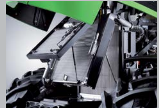
Dômyselný systém výklopných chladičov uľahčuje pravidelné čistenie a údržbu.
