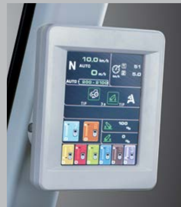
Na výber sú tri režimy jazdy. Manual, AUTO a PTO. Ich stav je zobrazený na integrovanom Work monitore.
