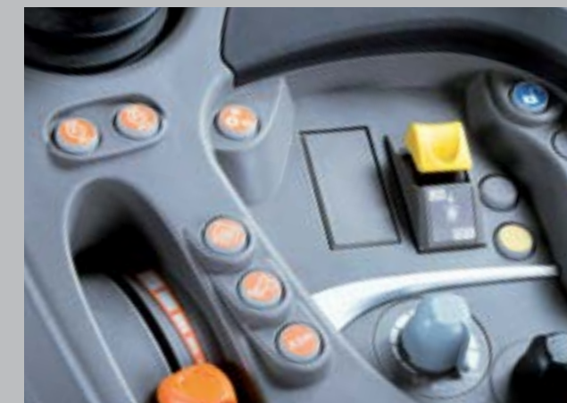
Ovládacie prvky nastavenia a aktivácie vývodových hriadeľov sú integrované do laktvej opierky...
