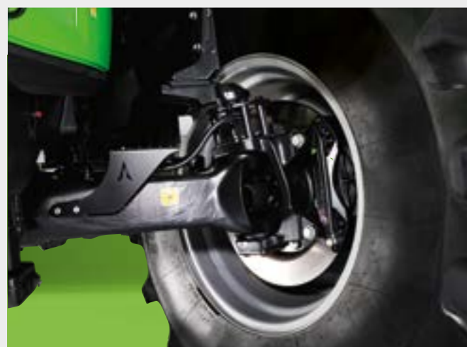
↑ Suché kotúčové brzdy s maximálnym brzdovým účinkom.
