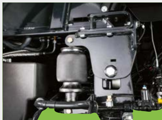
↑ Pneumatické odpruženie kabíny pre hladkú a komfortnú jazdu.
