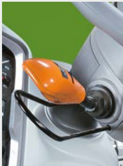
Elektrohydraulická reverzácia pod zaťažením s funkciou Sense Clutch
