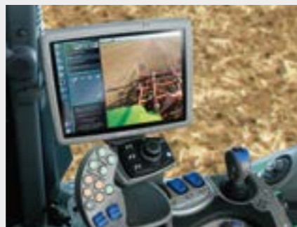
↑ Integrovaná kamera s automatickým zväčšením (napríklad pri cúvaní) pre jasný prehľad a bezpečnosť.
