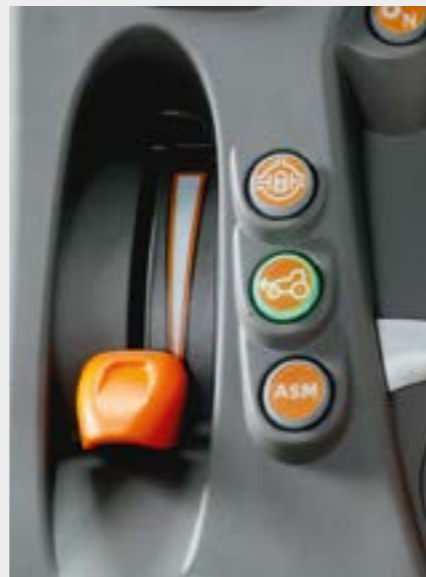
Elektro-hydraulicky ovládaný pohon prednej nápravy a uzávierky diferenciálu vrátane funkcie ASM.
