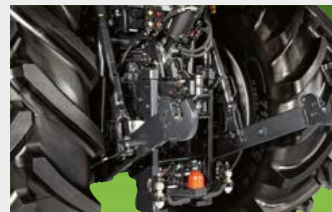
Vysoký zdvih ramien je optimálny pre použitie v preprave.
