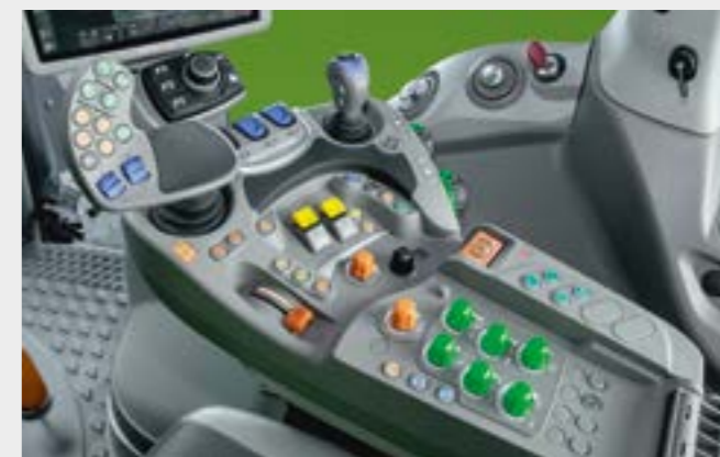
Overené DEUTZ-FAHR rozloženie ovládacích prvkov zoskupené podľa farieb zvyšuje intuitívnosť ovládania.
