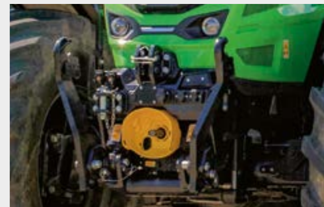
5 450 kg zdvižnej kapacity a dvojrychlostný vývodový hriadeľ vpredu.
