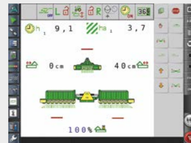
Korekčné signály ako Egnos, TopNet Global D, alebo RTK možno prijímať s novým prijímačom SR20.
